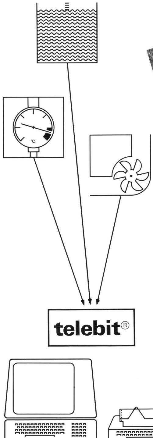
Das Fernwirksystem Telebit sorgt dafür, dass Messwerte und Informationen von dezentralen Betriebspunkten genau erfasst, sicher in zentrale Leitstellen übertragen und dort automatisch verarbeitet und angezeigt werden. Die Signalübertragung erfolgt über private Kabel- oder öffentliche Telefon-Netze, in Trägerfrequenztechnik, z.B. auch über Hochspannungsleitungen, über Lichtwellenleiter- und Funkverbindungen.
