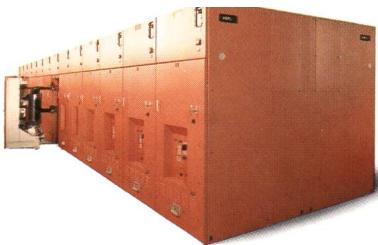
BBC-Mittelspannungsschaltfelder für Innenraumaufstellung gibt es für Spannungen bis 36 kV, 50 und 60 Hz, Nennströme bis 4000 A und Kurzschlussfestigkeit bis 50 kA.
