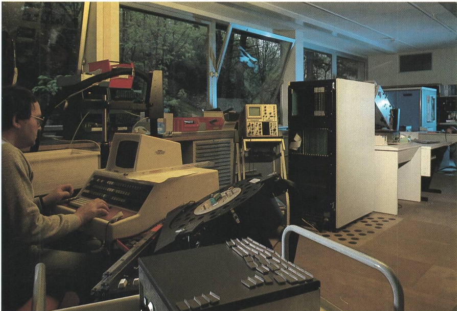
Prüfbereich des CSEE. In der Mitte der neue Prüfautomat Sentry 10; im Vordergrund ein Mitarbeiter am Terminal des Accutest-7700-Speichertesters.
