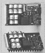
Ausgangsspannung oder 2×36 V, die DC-Eingangsspannung 24 bzw. 48 V. Die Geräte sind als Steckkarte im Europaformat aufgebaut mit einer Bauhöhe von max. 50 mm. Im Fühlerbetrieb sind Spannungsabfälle an den Leitungen zum Verbraucher bis zu 0,6 V ausregelbar. Eine Fernbedienung der Ein/Aus-Funktion ist mittels TTL-Signal oder Schalter ebenso möglich wie die Serienschaltung mehrerer Ge-(Dr. K. Witmer, räte. Elektronik AG, 8703 Erlenbach)
