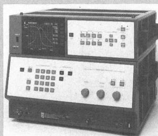
Verzerrungen von Netzwerken, also Frequenzgang der Dämpfung (Verstärkung), nichtlinearer Phasengang und Abweichung von konstanter Gruppenlaufzeit. Mit der bereits bekannten Messart «Spektrumanalyse» lassen sich nichtlineare Verzerrungen (Harmonische, Intermodulationsprodukte) und Störsignale messen. Beide Messarten sind notwendig, um die Eigenschaften von Netzwerken vollständig zu bestimmen.
