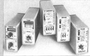
Komponenten erlaubt. Der Typ TZMK hat drei Funktionen, zwei programmierbare Zeiten von 0,1 s bis 10 min oder 0,1 min bis 10 h, zwei Ansteuervarianten sowie eine anwendungsorientierte Stop/Reset-Funktion. Das Angebot umfasst Typen bis zu 5 Funktionen und Zeiten bis zu 999,9 h. Das Zubehör für den industriellen Einsatz umfasst verschiedene Sockel, Frontrahmen, Abdeckhauben, Bezeichnungsmaterial usw.
