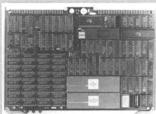
MHz-Taktfrequenz, 128 bis 512 KBytes RAM mit und ohne Parity sowie Real Time Clock, Floppy Disk Controller, serielle Interfaces und Printer-Port. Für den Ausbau zum Multiuser Unix-System stehen Hard Disk Controller, I/O-Multiplexer und Add-On Memories von 512 KBytes bis 2 MBytes zur Verfügung. Motherboards, Tisch- und Rack-Gehäuse vervollständigen das Hardware-Angebot.
