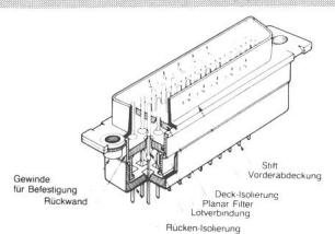
kung von elektromagnetischen Störstrahlungen von Computer-Kabelein- und -ausgängen und stehen in gerader oder abgewinkelte Ausführung zur Verfügung.
