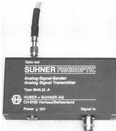
Fig.1 Sendermodul des Fiberoptic-Übertragungssystems
