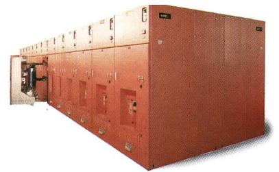
BBC-Mittelspannungsschaltfelder für Innenraumaufstellung gibt es für Spannungen bis 36 kV, 50 und 60 Hz, Nennströme bis 4000 A und Kurzschlussfestigkeit bis 50 kA.
