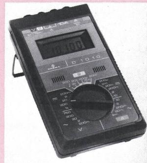
Eigenstromverbrauch. Eine Warnanzeige fordert zum Ersetzen der Batterie auf.
