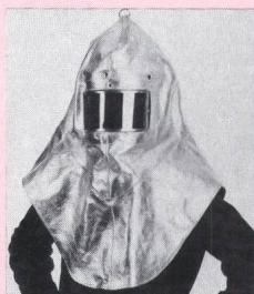
Kopfschutzauben aus. Sie schützen zuverlässig vor Strahlungshitze, sind zur Verstärkung dieser Schutzwirkung einseitig im Hochvakuum aluminisiert und mit einer in einem starren Aluminiumprofilrahmen sicher verankerten Sichtscheibe ausgerüstet. Trotz der festen Halterung können die Scheiben problemlos ausgewechselt werden. Die Haube liegt sicher und ohne zu beanspruchen auf Schultern, Brust und Rücken auf. Sie kann auch dem Industriehelm ohne spezielle Halterung angepasst werden.
