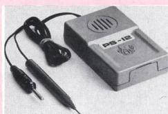
und Bauteilen (Widerstände, Kondensatoren, Spulen, Halbleiter usw.) wird ein handliches, robustes Spannungs- und Durchgangsprüfgerät angeboten. Das Messergebnis wird auf Tonhöhe und Lautstärke abgestimmt und akustisch angezeigt. Das Gerät enthält einen Piezokeramik-Summer, zwei Messspitzen, ist elektronisch fremdspannungsgesichert und
