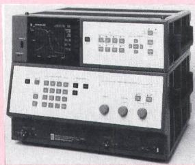
«werkanalyse» dient zur Ermittlung der frequenzabhängigen Verzerrungen von Netzwerken, (Frequenzgang der Dämpfung, nichtlinearer Phasengang, Gruppenlaufzeit). Mit der bereits bekannten Messart «Spektrumanalyse» lassen sich nichtlineare Verzerrungen (Harmonische, Intermodulationsprodukte) und Störsignale messen. Beide Messarten sind notwendig, um die Eigenschaften von Netzwerken vollständig zu bestimmen.
