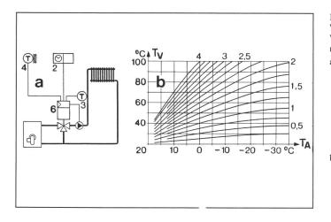
Fig. 2 Witterungsgeführte Vorlauf-Temperaturregelung
