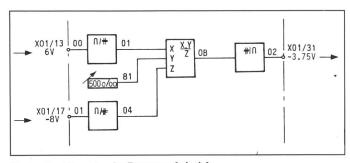
Fig. 1 Funktionsplan des Programmbeispiels
