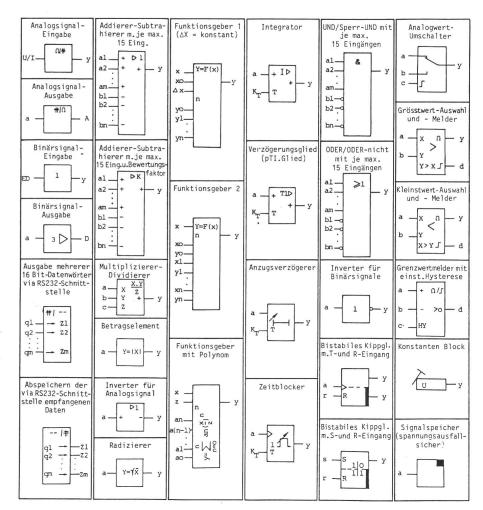
Fig. 4 Verfügbare Funktionsblöcke
