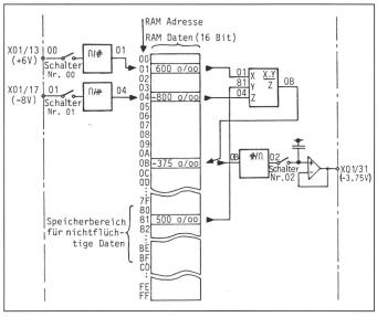
Fig. 2 Zusammenwirken von Programm und RAM
