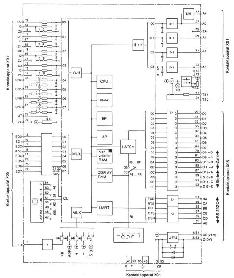
Fig. 3 Funktionsschaltbild des Gerätes PT 8153
