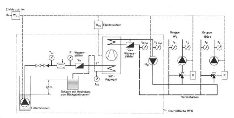
Fig. 1 Schaltschema der Wärmepumpenanlage
