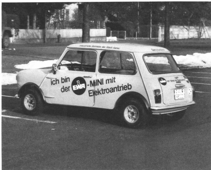
Fig. 1 Der ehemalige Elektro-Mini des EWA. Ein Zweiplätzer mit einem umfangreichen Batteriepaket im Heck des Fahrzeuges
