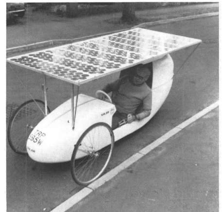
Fig. 3 Dasselbe Solarmobil in einer Variante ohne Zusatzantrieb
