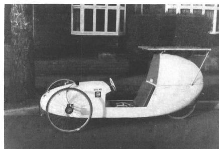
Fig. 2 Englisches Solarmobil mit zusätzlichem Pedalantrieb
