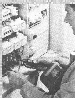
zur Prüfung der Fehlerstrom-Schutzeinrichtung (FI-Schutzschaltung), ein Schleifenwiderstandsmessgerät, ein Erdungsmessgerät nach dem Strom-Spannungs-Messverfahren und ein Spannungsmessgerät für bis zu 450 V~. Damit lassen sich die notwendigen Messungen in Starkstromnetzen einfach durchführen. Die Messwertanzeige ist digital. Fehler in der Anlage werden automatisch erkannt und optisch angezeigt.
