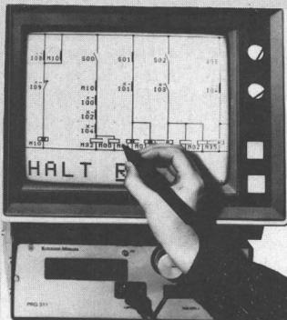
Lichtgriffel entwickelt. Ohne Tastatur wird der Stromlaufplan als SPS-Programm aufgebaut, indem mit dem Lichtgriffel die Kontakt-, Spulen- oder Zähler-Schaltzeichen im Menü-Feld abgegriffen und in die gewünschte Position auf dem Bildschirm gesetzt werden. Parallel- und Reihenschaltungen, Kreuzungen mit und ohne Knotenpunkte und Potentiallinien können gebildet werden. Es lassen sich Zähler, Zeitgeber sowie Schrittschaltwerke programmieren.
