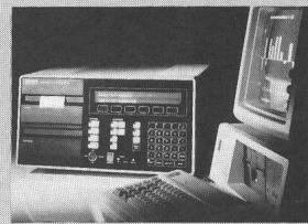
fassung und -verarbeitung eine aus Datenlogger ORION und XT-Version des IBM PC bestehende Systemkonfiguration auf den Markt gebracht. Aufgaben wie Datenerfassung, Datenverarbeitung, Datenreduktion, Abspeichern auf Harddisk sowie Erstellen von aussagefähigen Unterlagen in Form von Plots oder Listings werden von dieser Kombination durchgeführt, ohne dass hiefür teure Spezialsysteme beschafft werden müssen.
