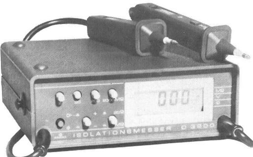
Große Isolationswiderstände und kleine Leitungs- und Übergangswiderstände bestimmen die Sicherheit elektrischer Anlagen und Geräte. Der digitale ISOLATIONSMESSE D 3900 ist ein Profi im Messen dieser Werte und überprüft elektrische Einrichtungen nach den neuesten einschlägigen Vorschriften.
