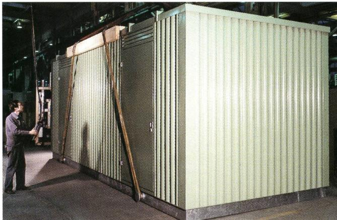
BBC-Mittelspannungsschaltfelder für Innenraumaufstellung gibt es für Spannungen bis 36 kV, 50 und 60 Hz, Nennströme bis 4000 A und Kurzschlussfestigkeit bis 50 kA.
