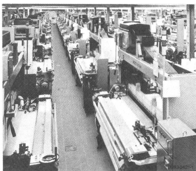
Fig. 1 Webmaschinenanlage mit 192 Sulzer-Rüti-Luftdüsenwebmaschinen Arbeitsbreite: 1900 bis 3600 mm Herstellprogramm: Oberbekleidungs- und Futterstoffe sowie technische Gewebe
