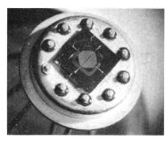
Fig. 6 Exemple de montage pour un capteur de gaz intégré
