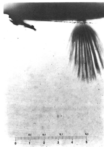
Fig. 7 Wasserbäumchen, ausgehend von einer glatten Stelle der Leitschicht
