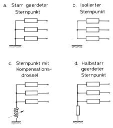
Fig. 1 Sternpunktschaltungen in Mittelspannungsnetzen
