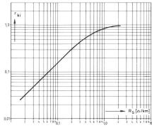
Fig. 8 Mantelstromreduktionsfaktor  $r_{ki}$  bei 50 Hz in Funktion des Mantelwiderstandes  $R_s$
