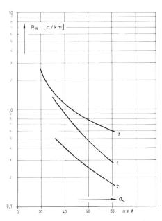
Fig. 7 Richtwerte für den Mantel-Längswiderstand  $R_{\rm s}$  bei etwa 50 °C in Funktion des Mantel-Innendurchmessers  $d_{\rm s}$
