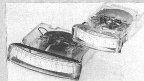
Baugrößen erhältlich: Baugröße 4E mit Skalenlänge 34,5 mm und Baugröße 5E mit Skalenlänge 48,6 mm. Die Instrumente sind horizontal oder vertikal stapelbar und sehr einfach in den Frontplattenabschnitten zu befestigen. Lieferbar sind DC- und AC-Varianten, zum Teil mit externem Komponentenprint.
