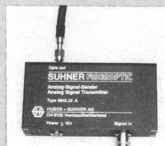
teilen der Lichtleitertechnik wie störungsfreie Übertragung, galvanische Trennung, geringe Streckendämpfung usw. profitieren, ohne sich um Probleme der Lichtleitertechnik zu kümmern. Suhner Fiberoptic liefert auch passende Kabel und Verbindungen. (Huber + Suhner AG, 9100 Herisau)
