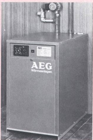
**Standardmodell:** Verschalter Heizkessel mit 50 l Inhalt. Ausgerüstet mit Chromnickel-Heizstäben, zwei Schaltstufen, Regulier- und Sicherheitsthermostat, Füllhahn, aluminiumbeschichtete 100 mm starke Steinwollisolation. Im fertig verdrahteten Elektroschaltkasten sind Anschlussklemmen für einen Raumthermostaten oder Mischer sowie für die Heizungspumpe vorgesehen.
