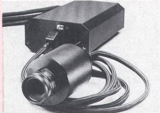
Die digitale Ortsangabe jedes einzelnen pixels und des dazugehörigen Helligkeitswertes – digitalisiert mit 6 Bit, d. h. 64 Helligkeitsstufen – ermöglichen eine optimale Mustererkennung im gesamten Bereich des Überganges zwischen Videotechnik und Automatisierung. Die kleinen Abmessungen des Kameraauges erleichtern den Einbau auch an schwer zugänglichen Stellen. (Henz AG,
