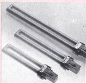
Eine Verbreiterung erhält so dann die Reihe der Kompakt-Leuchtstofflampen Lynx, die als «Doppel-Lichtrohr» mit einseitiger Sockelung (Bild) nun in sieben Ausführungen erhältlich ist. Eine Stromersparnis bis zu 75% und eine Lebensdauer von 5000 h kennzeichnen diese alternative Lichtquelle für Hotelbeleuchtung, in Schreibtisch- und Wandleuchten, in Außen- und Notleuchten oder als Schaukastenbeleuchtung.
