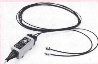
von 2 bis 8 cm durch Objekt-Reflexion (getrennte Sender und Empfänger). Der Kunststoff-Lichtleiter kann vom Anwender auf die gewünschte Länge gekürzt werden. Er besteht aus Glas oder Kunststoff, ummantelt mit Polyäthylen oder Stahl. Die stahlummantelte Optik arbeitet einwandfrei bei Umgebungstemperaturen von -40 °C bis +200 °C. Mit dem Zubehör kann man z.B. die Schaltreichweite um einen Faktor 10 bis 80 cm vergrößern oder auch den Lichtstrahl um 90° umlenken.
