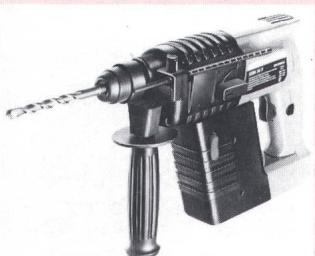
hoher Ladekapazität und geringer Innenwiderstand ist wartungsfrei und wird über ein zugehöriges Ladegerät aufgeladen. Die Leistungsabgabe erlaubt das Hämmern von Löchern von 4-14 mm in Beton über ein pneumatisches Hammerwerk mit Rotationsschwinger. Ohne Schlagwerk bohrt das Gerät in Stahl bis 13 mm, in Holz bis 20 mm Durchmesser. Eine Sicherheits-Ausrastkupplung verhindert das Herumschleudern des Gerätes bei blockiertem Bohrer.
