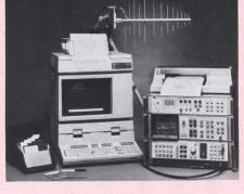
Hewlett-Packard stellt neues Softwarepaket zur Unterstützung von Messungen elektromagnetischer Verträglichkeit vor. Diese BASIC-Programme für die Tischrechner HP9826 und HP9836 steuern die Spek-
