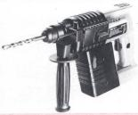
hoher Ladekapazität und geringem Innenwiderstand ist wartungsfrei und wird über ein zugehöriges Ladegerät aufgeladen. Die Leistungsabgabe erlaubt das Hämmern von Löchern von 4-14 mm in Beton über ein pneumatisches Hammerwerk mit Rotationsschwinger. Ohne Schlagwerk bohrt das Gerät in Stahl bis 13 mm, in Holz bis 20 mm Durchmesser. Eine Sicherheits-Ausrastkupplung verhindert das Herumschleudern des Gerätes bei blockiertem Bohrer.
