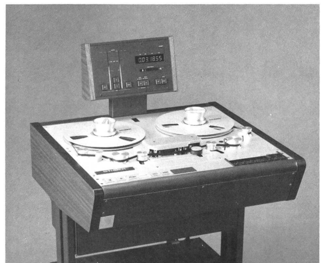
Fig. 7 Prototyp des DASH-Recorders D 820 (19 cm/s, 2 Kanäle)
