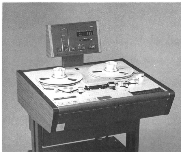
Fig. 7 Prototyp des DASH-Recorders D 820 (19 cm/s, 2 Kanäle)
