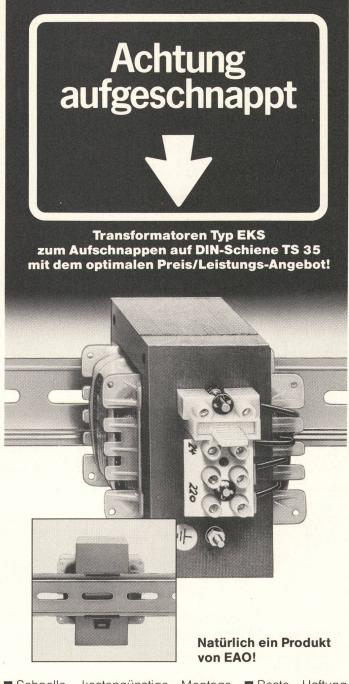
■ Schnelle, kostengünstige Montage ■ Beste Haftung der Schnappvorrichtung ■ Keine Schrauben und Muttern ■ Optimale Platzausnützung ■ Anschlussklemmen mit integrierter Feinsicherung ■ SEV-geprüft ■ Standard-Lagertypen: Primärspannung: 220 V; Sekundärspannung: 24 V, 48 V; Leistungsbereich: 60, 110, 160 VA ■ Andere Leistungen und Spannungen auf Anfrage ■ EAO-Qualität
