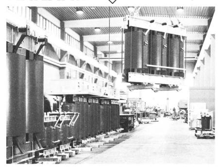
MAYLAMID-Leistungstransformatoren haben seit 20 Jahren immer breitere Anwendungsgebiete erschlossen, weil sie keine brennbaren Kühlflüssigkeiten benötigen und dennoch bessere oder gleichwertige elektrische Qualitätsmerkmale aufweisen als Öltransformatoren. Ihre Stoßkurzschluß- und Stoßspannungsfestigkeit ist hervorragend. Glasfaserverstärkte Wicklungen werden vollständig in Epoxydharz in Formen nach einem speziellen, patentierten May & Christe-Verfahren unter Vakuum gegossen.
