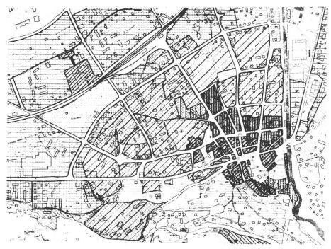
Fig. 7 Cadastre de la densité énergétique (vue partielle). Les densités différentes sont indiquées par différents types de hâchures.
