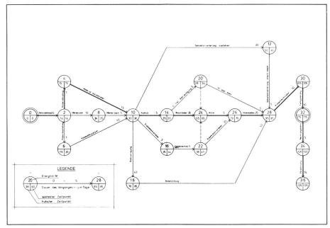
Fig. 6 Standard-Netzplan für die Errichtung von Transformatorenstationen
