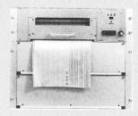
denabstand beträgt 0,5 bzw. 0,25 mm, so dass der ursprünglich punktförmige Charakter Aufzeichnung praktisch verschwindet und eine saubere, kontrastreiche Aufzeichnung entsteht. Die Elektroden werden über einen 8-Bit-Datenwert angesteuert, aber nicht bewegt: Damit entfallen die sonst beim Aufzeichnen notwendigen und die Dynamik begrenzenden Massen. Das Gerät ist mit 8 oder 16 Analogkanälen sowie mit 32 Binärsignalen ausrüstbar.
