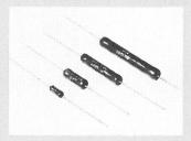
reich von  $0.047 \Omega$  bis  $120 k\Omega$ und Toleranzen bis ±1% erhältlich. Der Widerstandsdraht besteht aus CrNi- oder CuNi-Legierungen und ist auf einen Steatit-Keramikkörper mit hohem Reinheitsgrad und engsten Toleranzen gewickelt. Alle Endkappen sind aus einer NiFe-Legierung gezogen, und die Anschlussdrähte sind mit diesen verschweisst. Die feuchtigkeitsdichte Spezialglasur sowie der optimale Aufbau gewährleisten eine hohe Langzeitstabilität.
