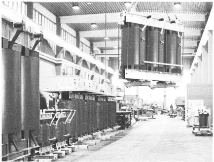
MAYLAMID-Leistungstransformatoren haben seit 20 Jahren immer breitere Anwendungsgebiete erschlossen, weil sie keine brennbaren Kühlflüssigkeiten benötigen und dennoch bessere oder gleichwertige elektrische Qualitätsmerkmale aufweisen als Öltransformatoren. Ihre Stoßkurzschluß- und Stoßspannungsfestigkeit ist hervorragend. Glasfaserverstärkte Wicklungen werden vollständig in Epoxydharz in Formen nach einem speziellen, patentierten May & Christe-Verfahren unter Vakuum gegossen.
