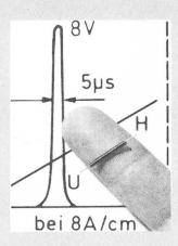
bieten sich die exakte Ermittlung von Weglängen, Positionen, Drehzahlen, Geschwindigkeit, der Aufbau kontaktloser Zündverteiler und Alarmsysteme an. Weitere Einsatzgebiete sind Speicherelemente, magnetische Code-Karten, elektrische Schlösser und kontaktlose Schalter.
