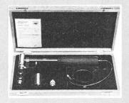
Im Zubehör des Typs 8202 sind drei auswechselbare Stossblättchen aus Stahl, Kunststoff und Gummi enthalten. Mit diesen lässt sich die Impulsdauer zwischen 0,2 ms und 5 ms variieren. Die maximale Kraft, die auf einen massiven, harten Prüfling einwirken kann, beträgt 5 kN.
