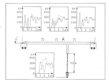
Fig. 10 Berechnete Überspannung
