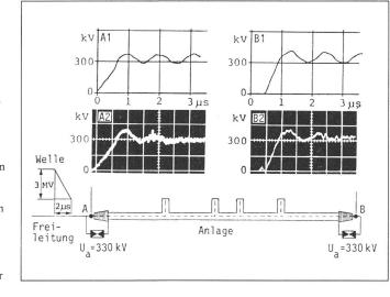
Fig. 7 Situation der Anlage Heilbronn bei der Berechnung der Blitzüberspannungen
