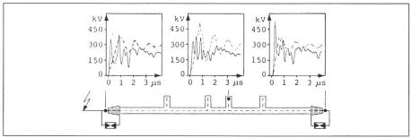
Fig. 8 Berechnete Überspannungen an der Anlage Heilbronn
