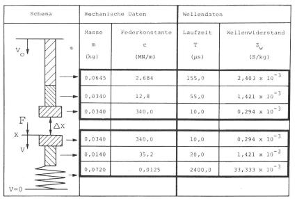
Fig. 13 Schema und Wellendaten eines Kontaktpaares zur Berechnung des Bewegungsvorgangs
