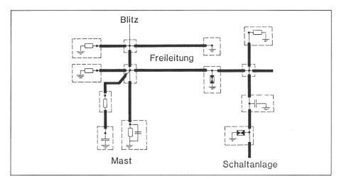
Fig. 2 Beispiel eines Netzwerkes aus Wellenleitern und Knotenbereichen
