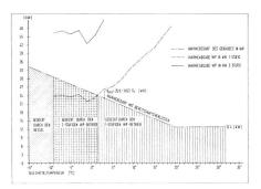
Fig. 4 Betriebskonzept der Wärmeerzeugung
