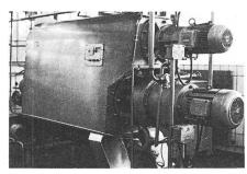
Fig. 1 Beispiel einer bei der Butterverarbeitung eingesetzten Anlage (Abkühlung der pasteurisierten Butter)
