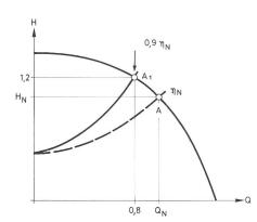
Fig. 2 Einfluss der Drosselung auf die Netzkennlinie
