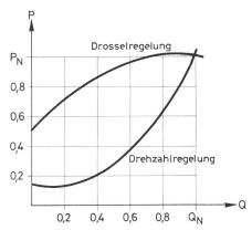
Fig. 5 Leistungsaufnahme in Abhängigkeit der Drehzahl für Drossel- und Drehzahlregulierung
