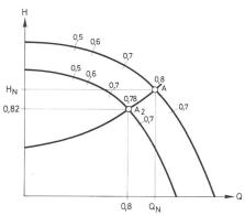
Fig. 4 Reduktion des Durchflusses durch Anpassen der Pumpendrehzahl
