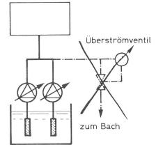
Fig. 9 Die Netzdruckregelung mit drehzahlvariablen Unterwasserpumpen macht den Überlauf überflüssig
