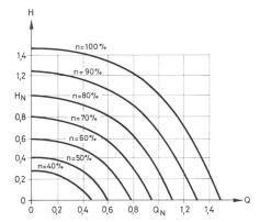
Fig. 3 Kennlinienschar bei Drehzahlregelung
