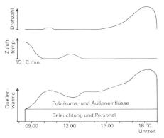
Fig. 8 Einsatz der Drehzahlregelung während eines Tages
