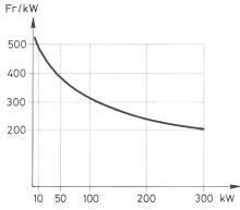
Fig. 7 Preis pro Kilowatt in Abhängigkeit der Umrichterleistung
