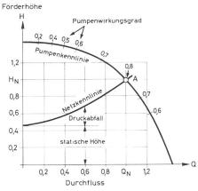
Fig. 1 Pumpenkennlinie für konstante Pumpendrehzahl
