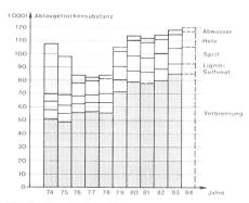
Fig. 3 Entwicklung Ablaugeverwertung Zunahme Verbrennungsanteil = 12 800 t/a Öläquivalent
