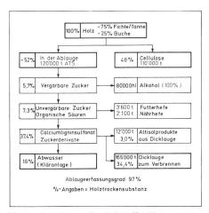
Fig. 1 Ausnützung des Rohstoffes Holz Produzierte Mengen/Jahr
