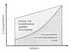
Fig. 6 Energieeinsparung durch drehzahlveränderbare elektrische Antriebe
