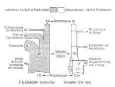
Fig. 8 Wärmen von Stahlstangen zum Gesenkschmieden (Stahlstangen Ø 35 mm, Erwärmung auf 1200 °C, Stromerzeugungsstruktur Durchschnitt Schweiz 1982)
