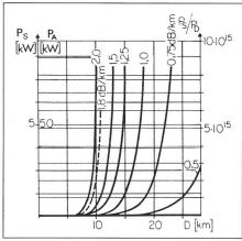
Fig. 13 Leistungsbedarf für ein CO2-Laserradar
