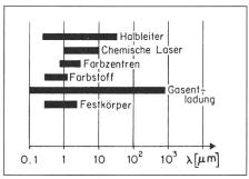
Fig. 3 Bereiche realisierbarer Wellenlängen für einzelne Lasertypen
