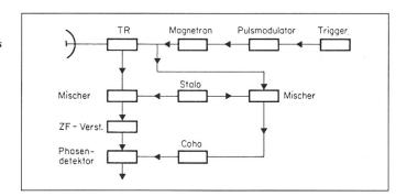
Die Verwendung einer zusätzlichen Zwischenfrequenz und eines zusätzlichen STALO (Stable Local Oscillator) ist in der Lasertechnik nicht nötig.
