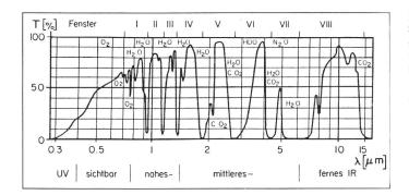
Fig. 2 Spektrale Transmission der Atmosphäre, Definition der atmosphärischen Fenster
