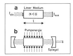
Fig. 1 Prinzip des Lasers a Lichtverstärkung:  $I_{aus} = I_{ein} e^{-\alpha l}$ ,  $\alpha < 0$  b Laser
