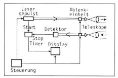
Fig. 7 Aufbau eines Ladars mit direkter Detektion
