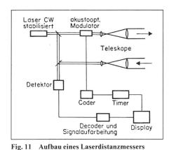
mit Chirp-Modulation und heterodyner Detektion zur simultanen Messung von Distanz und Radialgeschwindigkeit
