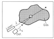
Prinzip des Lidar
