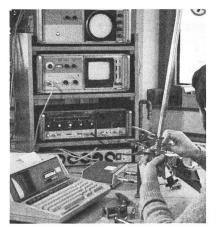
Fig. 6 Vektor-Netzwerkanalysator
