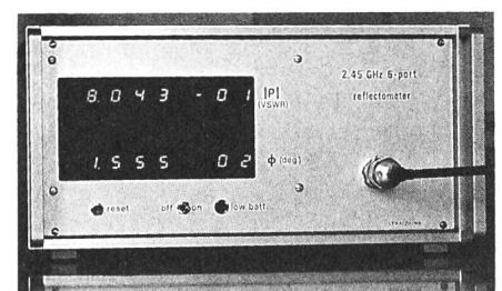
Fig. 5 Le réflectomètre à hexaporte complet, y compris la source de signal à 2450 MHz (MESFET) et l'alimentation par batteries
