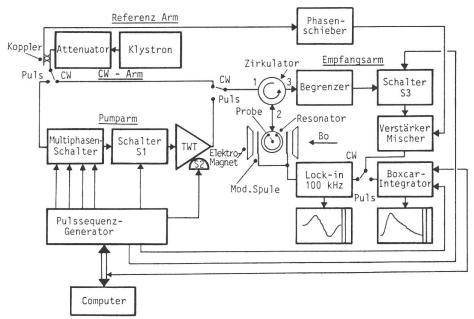
Fig. 4 Vereinfachtes Blockdiagramm des Elektronen-Spin-Echo-(ESE-)Spektrometers
