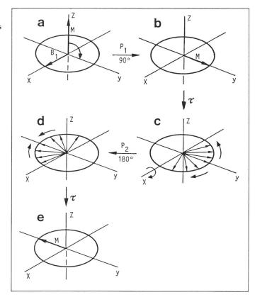
krowellenfrequenz  $f_0$  um die z-Achse rotiert. Von diesem Koordinatensystem aus gesehen wird durch einen kurzen Mikrowellenimpuls  $P_1$  (typische Pulsdauer  $t_{90^\circ}=5...50$  ns) der Magnetisierungsvektor M von der z-Achse in die y-Achse gedreht. Der Zusammenhang zwischen Drehwinkel  $\alpha$ , magnetischer Flussdichte  $B_1$  und  $t_{90^\circ}$  ist gegeben durch
