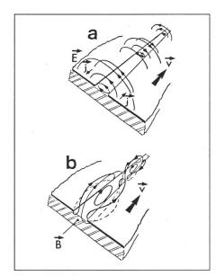
Fig. 1 Schlitzleitung a elektrisches Feldlinienbild b magnetisches Feldlinienbild
