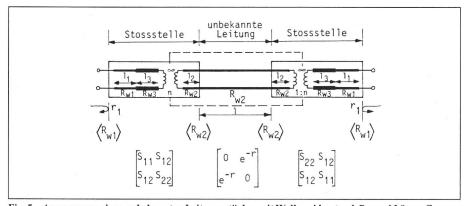
Fig. 5 Ausmessung eines unbekannten Leitungsstückes mit Wellenwiderstand  $R_{w2}$  und Länge C Zwei Verbindungszweitore schliessen es an die Messapparatur des bekannten Wellenwiderstandes  $R_{w1}$  an. In der Streumatrix für die Gesamtschaltung kommt  $R_{w2}$  nur in Form des Produktes  $n^2R_{w2}$  vor, ist also vom ebenfalls unbekannten Verbindungszweitor nicht zu trennen.
