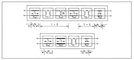
Fig. 4 Zerlegung des Zweitores der Stossstelle
