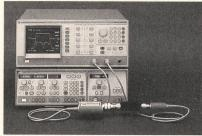
Der abgebildete skalare Netzwerk-Analysator besteht aus dem Empfangsteil HP 8756A und dem Wobbler HP 8350B. Dank modernster Mikroprozessoren sind die Messungen schneller, einfacher und wesentlich genauer.
