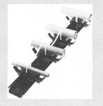
binder befestigt werden. Die Halter – die es für Kabel-Ø 6–9 mm, 9–12 mm, 12–16 mm und 16–20 mm gibt – können problemlos auf die Tragschiene aufgeschnappt werden. Sie können bei Änderungen auch ohne weiteres entfernt werden. Mit diesen praktischen Kabelhaltern kann im Schaltschrank Ordnung gehalten werden, zudem kommt man inskünftig im Innern des Schaltschranks allein mit der Tragschiene nach DIN 46277/3 aus.
