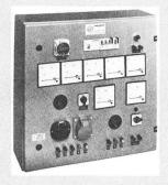
Wechsel- und Drehstrom sowie nach CEE-Norm wurden ebenso eingebaut wie die erforderlichen Leistungsautomaten mit abschaltbarem Nulleiter und FI-Schutzschalter mit dem Schweizer Prüfzeichen. Einsatzgebiete der Werkstattprüftafel sind kleinere Werkstätten von Handwerk, Handel und Industrie. Sie ermöglicht Messungen an Wechsel- und Drehstromgeräten, Kleinspannungsentnahme bis 42 V, optische Durchgangsprüfung, Spannungsmessungen und derglei-(Julius Fischer AG, chen. 8021 Zürich)
