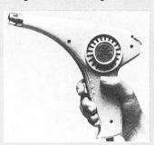
geformten Griff ist das Ungar-Heissluftgebläse besonders für den Einsatz in der Industrieelektronik geeignet. Die Luftstromtemperatur - gemessen in 25 mm Abstand von der Austrittsdüse - beträgt 265 °C. Vier verschiedene Vorsatzdüsen werden mit jedem Gerät mitgeliefert. Ein Tischständer ist als Zubehör erhältlich. Das Heissluftgebläse 6966M eignet sich speziell zum Schrumpfen, Löten, Entlöten, Aushärten, Erhitzen und Kühlen.
