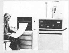
Die Analyse kristalliner Substanzen durch Röntgenbeugung – ein auch in der Grundstoffindustrie routinemässig eingesetztes Verfahren – erfordert schnellen Probedurchsatz und einfache Bedienung. Beides ist im neuen, sehr kompakten automatischen Röntgen-Pulverdiffraktometer PW 1840 von Philips verwirklicht.
