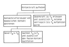
Fig. 5 Massnahmen zum Aufheben der Kontaktkraft
