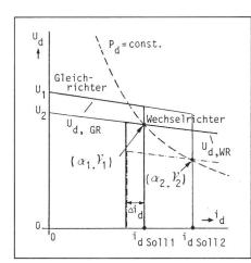
Fig. 2 Regelkennlinien einer HGÜ
