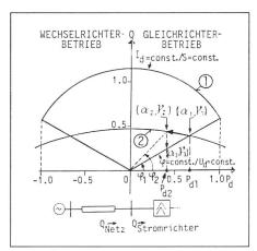
Fig. 5 Überlagerte Leistungsdiagramme Stromrichter und Netz
