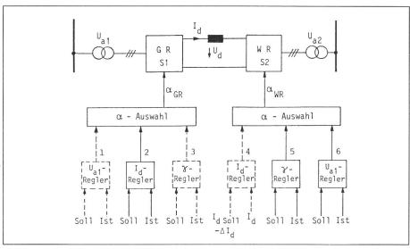
Fig. 4 Regeleinrichtung einer HGÜ mit Wirkleistungs- und Spannungsregelung sowie Löschwinkelbegrenzung
