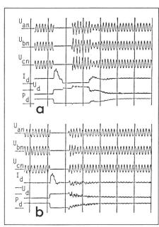
Fig. 7 Transientes Verhalten bei wiederkehrender Spannung
