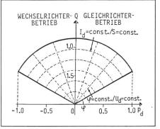
Fig. 3 Wirk-Blindleistungsdiagramm eines
