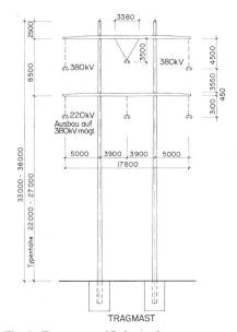
Fig. 4 Tragmast und Leitungsdaten
