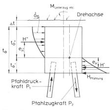
Fig. 10 Verteilung der Biegekräfte im Fundamentblock
