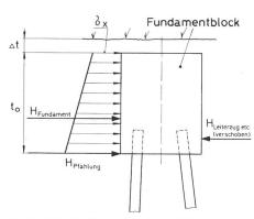
Fig. 9 Schubkräfte am Fundamentblock
