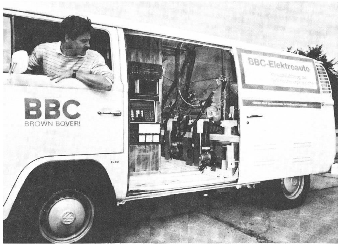
Fig. 1 Versuchsfahrzeug mit NaS-Batterie
