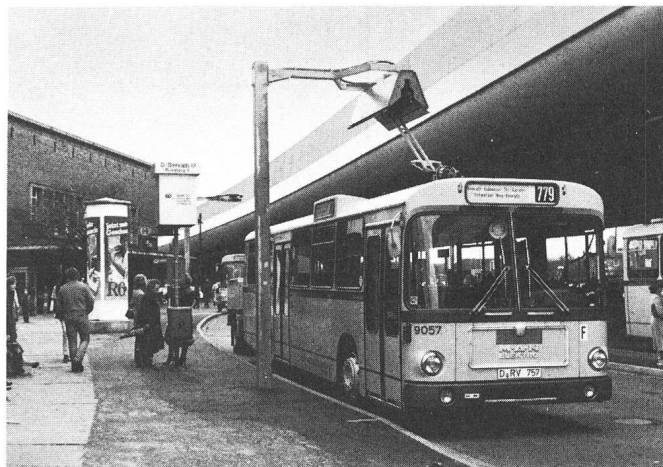
Fig. 1 Batterie-Elektrobus bei der Zwischenladung
