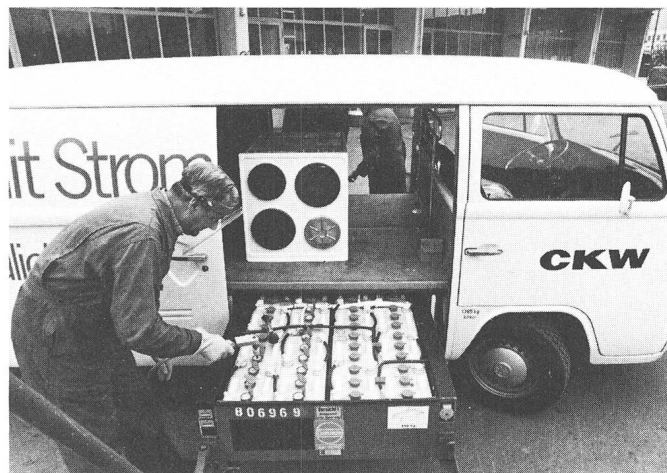
Fig. 2 VW-Elektrotransporter der CKW mit ausgefah- rener Batterie
