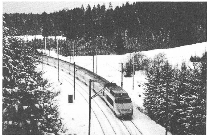
Fig. 6 Photo TGV-PSE. Rame tricourant allant en Suisse
