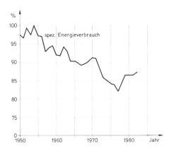
Fig. 6 Mittlerer spezifischer Energieverbrauch der SBB pro Bruttotonnenkilometer ab Unterwerk
