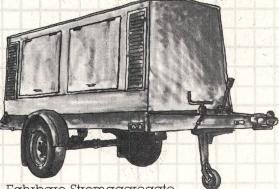
Fahrbare Stromaggregate von Senn sind mit Benzin- oder Dieselmotoren ausgerüstet. Auf Wunsch schallgedämpft. Leistung bis 1000 kVA.
