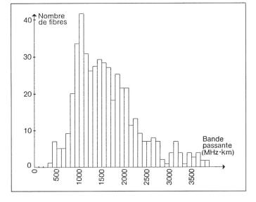
Histogramme de bande passante à 1,3 µm 472 fibres Bande passante movenne: 1.57 GHz · km Bande passante maximum: >4 GHz · km
