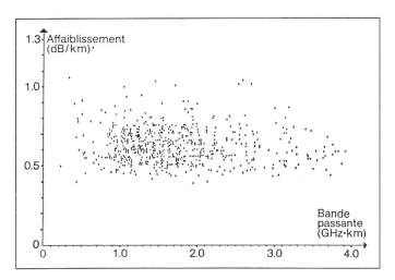
Distribution de fabrication de fibres optiques multimodes à gradient d'indice
