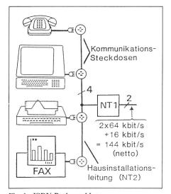
**Fig. 4 ISDN-Basisanschluss** mit Hausinstallationsleitung für max. acht Endgeräte
